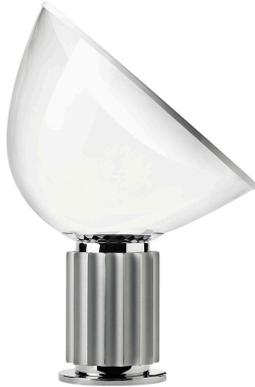
Apparecchio di illuminazione da tavolo a luce indiretta e riflessa. Riflettore in alluminio verniciato bianco lucido esternamente e bianco opaco internamente. Diffusore orientabile in PMMA trasparente. Corpo in alluminio estruso verniciato nero opaco o anodizzato naturale. Base in metallo nickelata. Cavo elettrico lunghezza utile 220 cm con interruttore dimmer che garantisce le funzioni ON/OFF e regolazione del flusso luminoso 10-100%. Power supply su spina con plug intercambiabili.
